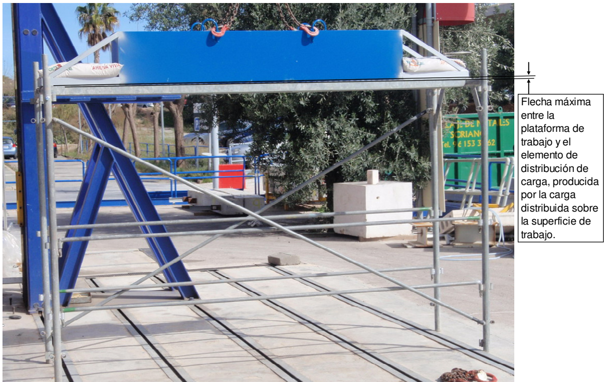
Fotografía 10: Detalle donde se puede observar la flecha máxima producida por la aplicación de la carga distribuida (54427-1)
