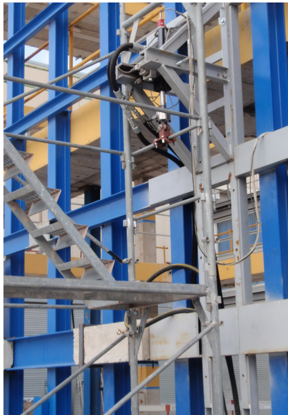
Fotografía 18: Instantánea aplicación de carga estática vertical ascendente sobre la zona más desfavorable de la barandilla principal (54427-3-2)
