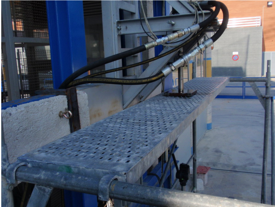
Fotografía 11: Instantánea de la aplicación de la carga concentrada sobre la superficie de 200x200mm sobre la unidad de plataforma de trabajo del módulo del andamio estructural de fachada objeto del ensayo (54427-2-1)
