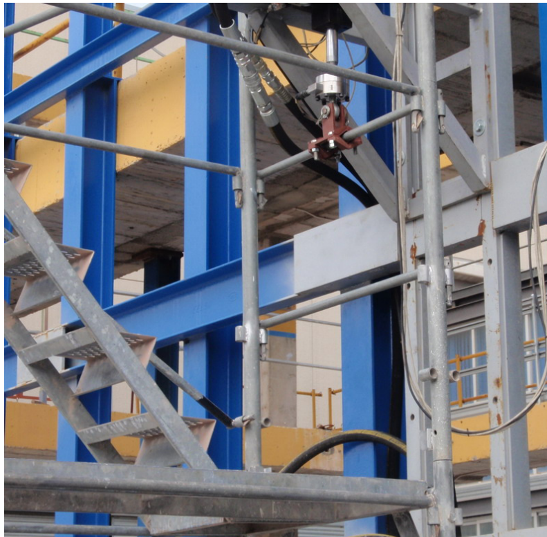
Fotografía 7: Vista de detalle de la muestra evaluada, durante proceso de ensayo, con 1 módulo de 2 alturas.
