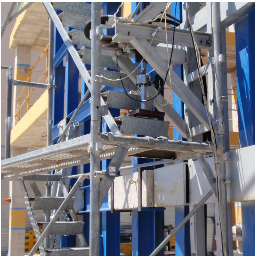
Fotografía 26: Instantánea ensayo de fatiga de peldaño de la escalera de acceso del sistema de andamio objeto de ensayo (54427-5)
