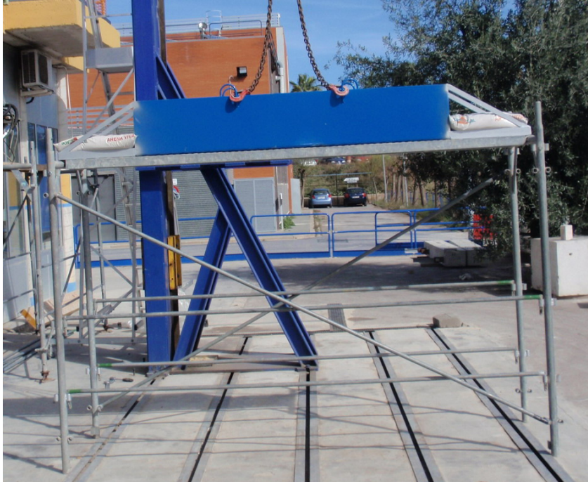
Fotografía 9: Detalle del ensayo de aplicación de carga distribuida sobre la plataforma de trabajo (54427-1)
