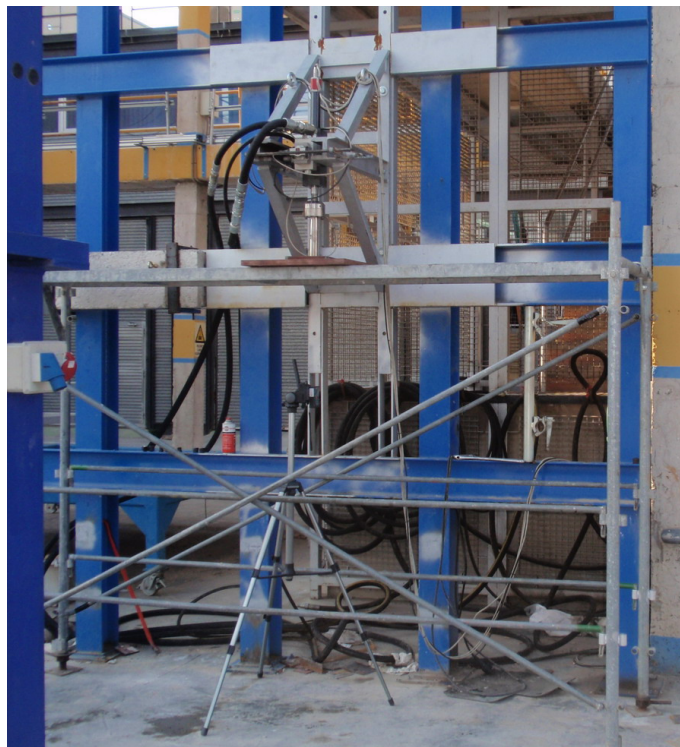
Fotografía 15: Vista general del momento de aplicación de la carga concentrada (54427-2-2)
