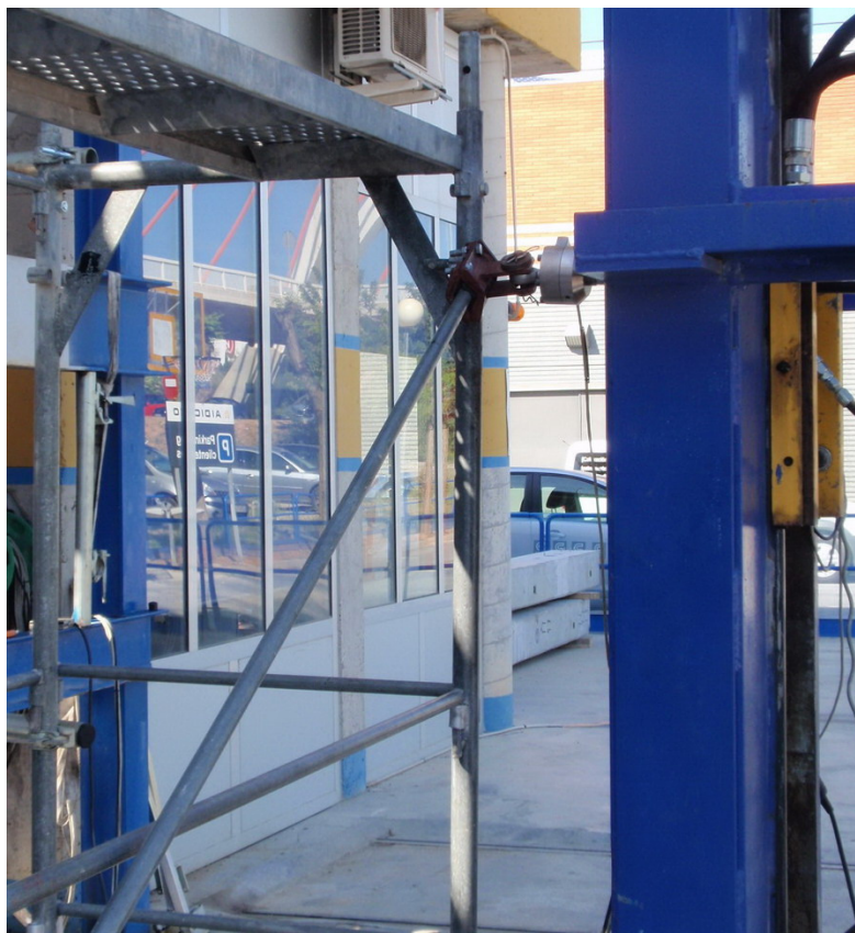
Fotografía 8: Vista de detalle de la muestra evaluada, durante proceso de ensayo, con 1 módulo de 1 altura.
