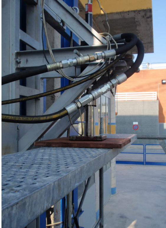
Fotografía 14: Instantánea aplicación carga concentrada en superficie de 500x500mm sobre unidad de plataforma de trabajo (54427-2-2)
