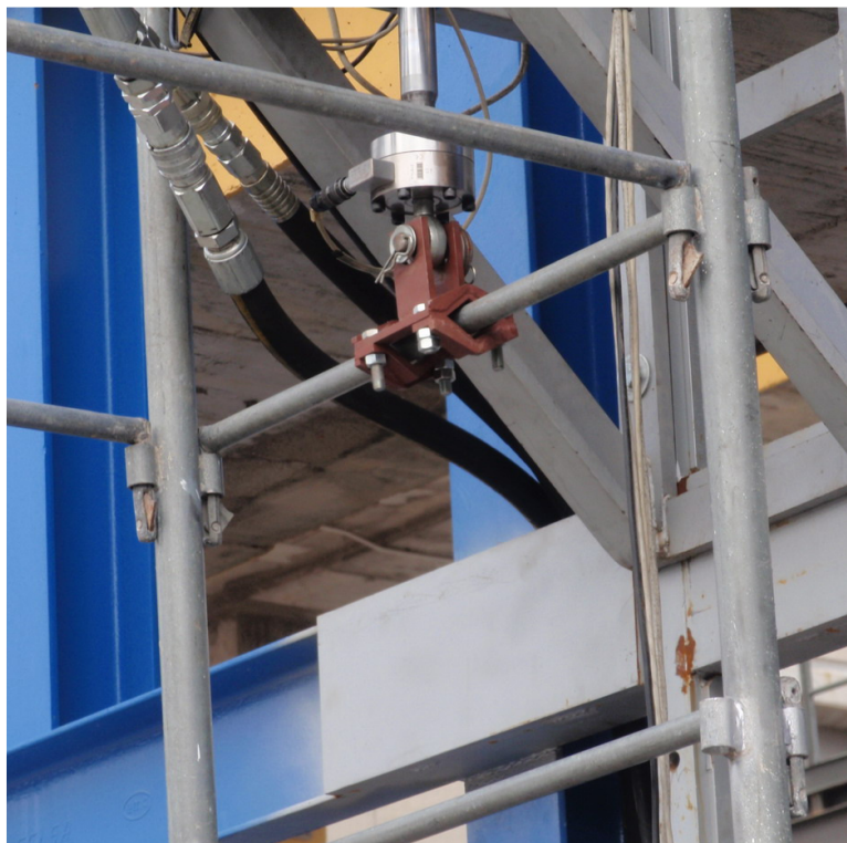
Fotografía 19: Detalle aplicación carga estática vertical ascendente (54427-3-2)
