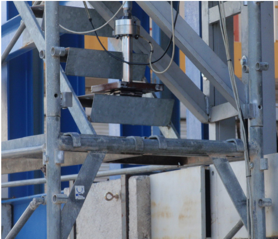
Fotografía 27: Detalle aplicación carga dinámica de vibración sobre peldaños de la escalera de acceso del andamio (54427-5)
