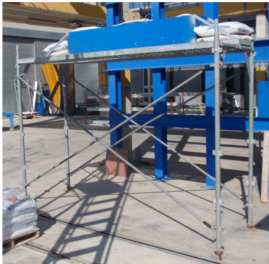
Fotografía 4: Vista general de muestra a evaluar, durante proceso de ensayo, con un módulo de una altura, en el que se pueden identificar los marcos verticales, las riostras diagonales, los husillos y las plataformas de trabajo.
