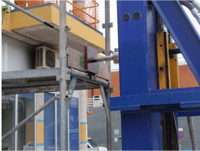
Fotografía 23: Detalle aplicación carga estática horizontal sobre rodapié (54427-3-3c)
