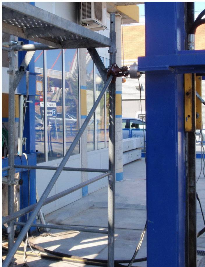
Fotografía 24: Instantánea ensayo de vibración, con actuador conectado junto al mecanismo de conexión de la diagonal con el montante (54427-4)
