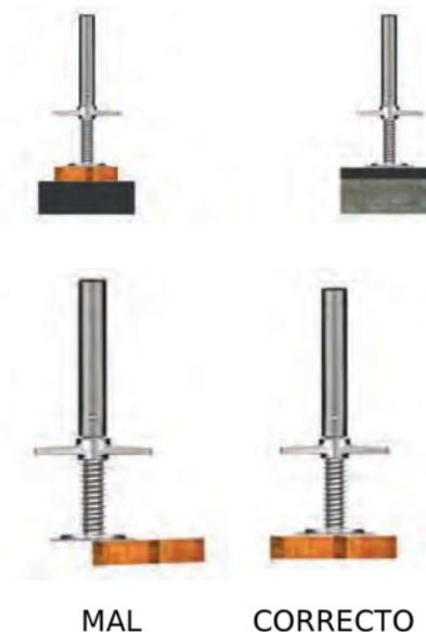
Se recomienda siempre colocar durmientes de madera de grosor suficiente. Se deberá comprobar que éstos se sitúan centrados para lograr una correcta transmisión de cargas.
