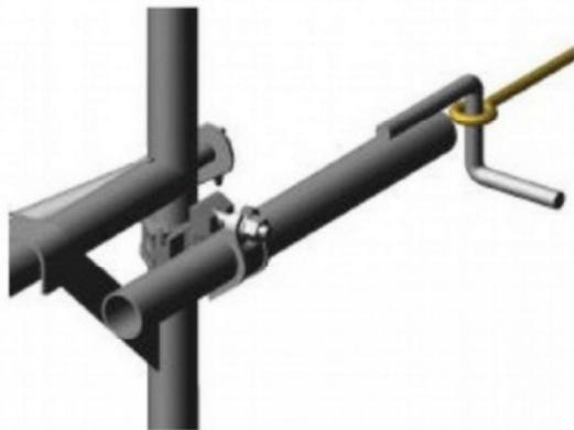
**Anclajes a fachada mediante abrazaderas de tubo y grapa en "F":**
